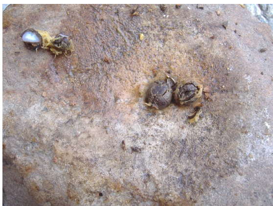
Fig.: 6. Mortero humedecido por aceite de Butiá.
